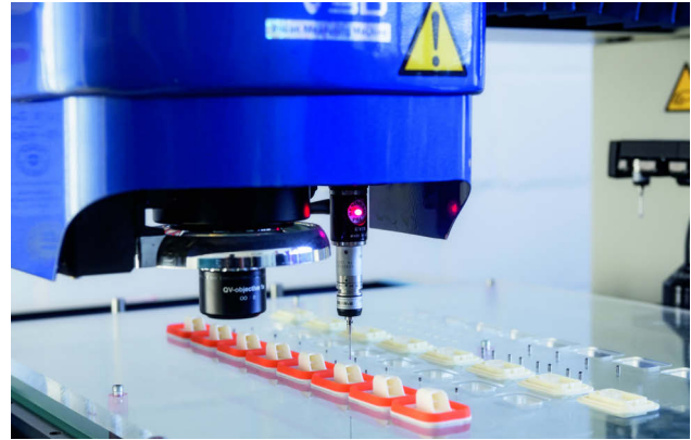
AQL Prüfung von 3K-LSR-Bauteilen
