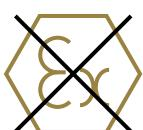
Die Standardausführung der Sava Hebekissen ist NICHT für die Verwendung in explosionsgefährdeten Bereichen geeignet.
