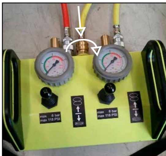
Slika 5.8: Priključitev dovodne cevi na kontroler
