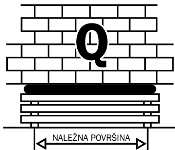
Slika 5.20: Skica podložne podpore in oznaka naležne površine
