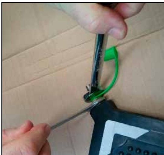
Slika 6.1: Zamenjava vtiča na dvižni blazini SAVA
