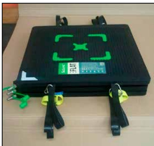
Slika 5.28: Postavitev ploskih/FLAT BAG dvižnih blazin SAVA v kombinacijo za povečanje dvižne višine
