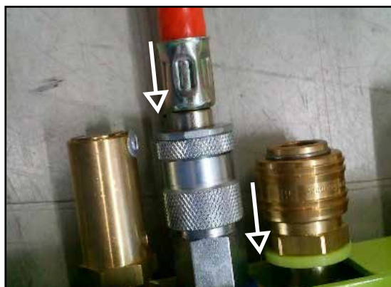
Slika 5.18: Odklop povezovalnih cevi s kontrolerja
