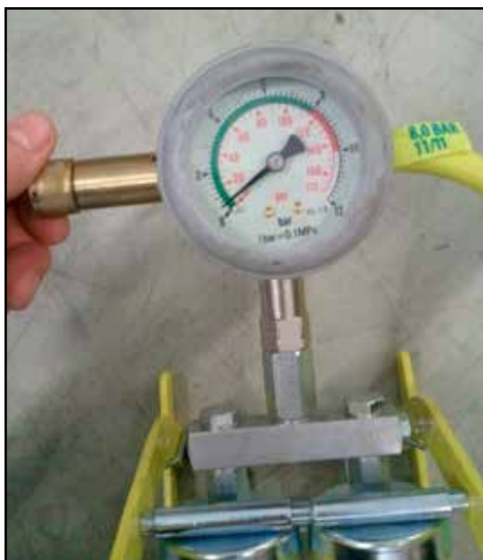
Slika 5.15: Privijanje oziroma odvijanje zaščitnega vijaka na varnostnem ventilu nožne tlačilke
