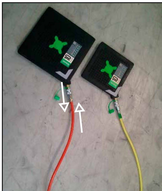
Slika 5.19: Odklop povezovalnih cevi z dvižne blazine SAVA
