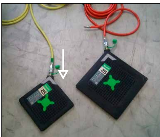
Slika 5.3: Priklučitev cevi na dvizno blazino SAVA
