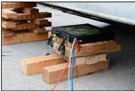
Slika 5.2: Postavitev dvizne blazine SAVA na mesto dviga
